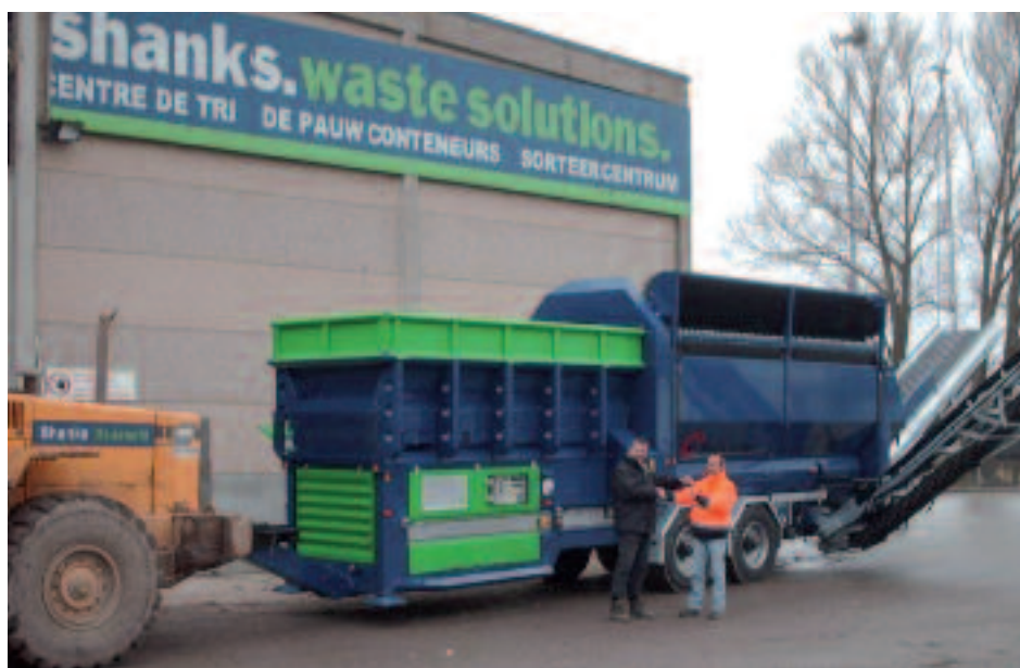
De Terra T6 is uitgerust met een Perkins Tier 3 dieselmotor van 90 kW (123pk).
