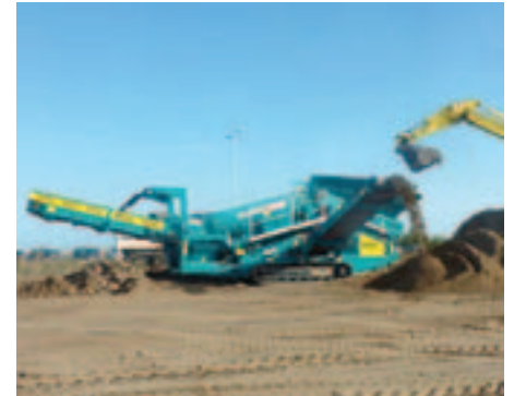
De ST1-machine aan het werk. De mobiele breker kan per dag zo'n 1.000 ton puin verwerken tot granulaat.
